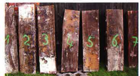
Abb. 6: Probematerial Balken 1-7 mit krustigen Belägen
