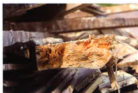
Abb. 6 und 7: kurzfasrige Bruchstellen: links während des Rückbaus entstandener frischer Bruch, rechts alter Bruch (substratgeschwärzt)
