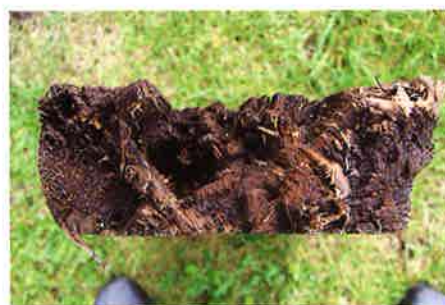
Abb. 6 und 7: kurzfasrige Bruchstellen: links während des Rückbaus entstandener frischer Bruch, rechts alter Bruch (substratgeschwärzt)
