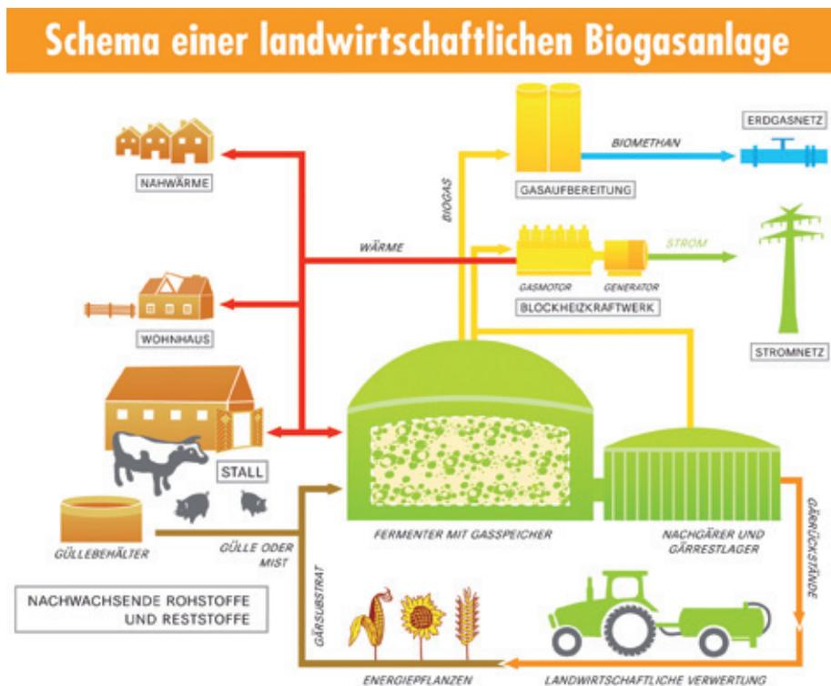
Abb. 22: Schema einer landwirtschaftlichen Biogasanlage; Quelle: Fachagentur Nachwachsende Rohstoffe e.V. (FNRR)
