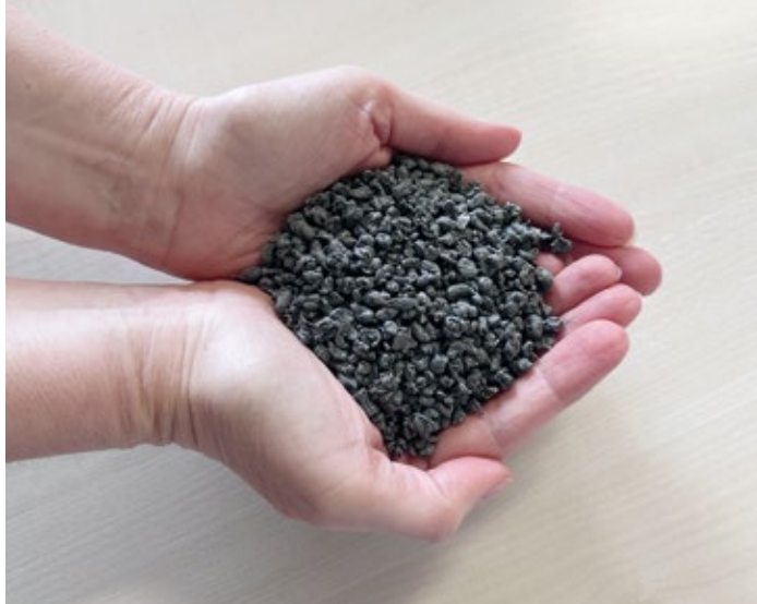
Rezyklat als Zusammenballung (Agglomerat) von PE mit PP-Anteilen als Einsatzstoff für die Kunststoffverarbeitung z.B. im Spritzgussverfahren oder durch Extrusion.
